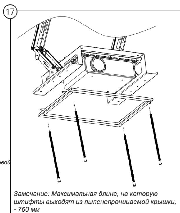
Замечание: Максимальная длина, на которую штифты выходят из пыленепроницаемой крышки, - 760 мм
